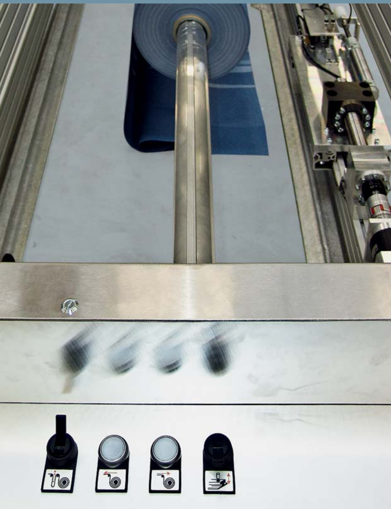
Handstürebene des Bahnrollenwagens, mit dem die Tuchrolle in die Maschine eingefahren wird
